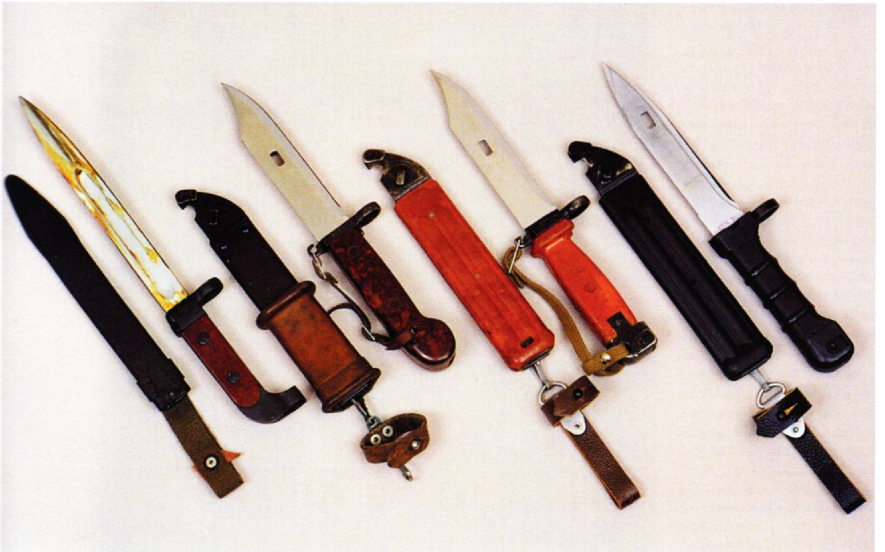
Эволюция штык-ножей автомата Калашникова, слева направо: первый вариант конца 60-х годов, вариант с эбонитовой рукояткой образца 1959 г., варианты с бакелитовыми рукоятками коричневого и черного цвета для автомата АК-74. На обушке лезвия крайнего справа штык-ножа сделана пила. Соединенные с ножнами штык-нож превращался в ножницы для резки колючей проволоки, рукоятка и ножны из изоляционного материала позволяли резать даже проволоку, которая находилась под напряжением.
